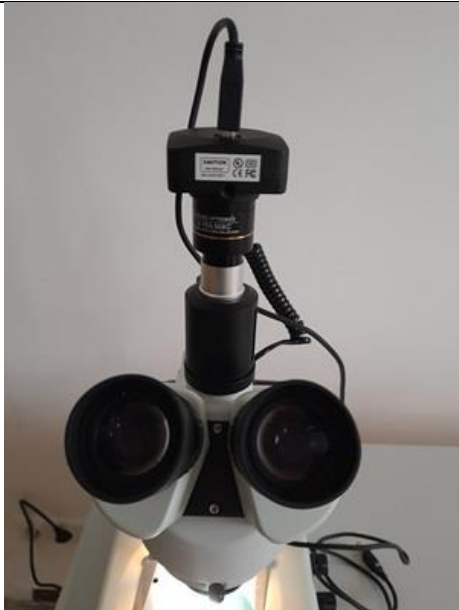
„Drittes Auge“ für die Beamer-Projektion: Montierte Kamera auf der Stereolupe
